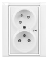
zásuvka dvojnásobná s natočenou vrchní dutinou, s ochranou před přepětím, s akustickou signalizací poruchy
